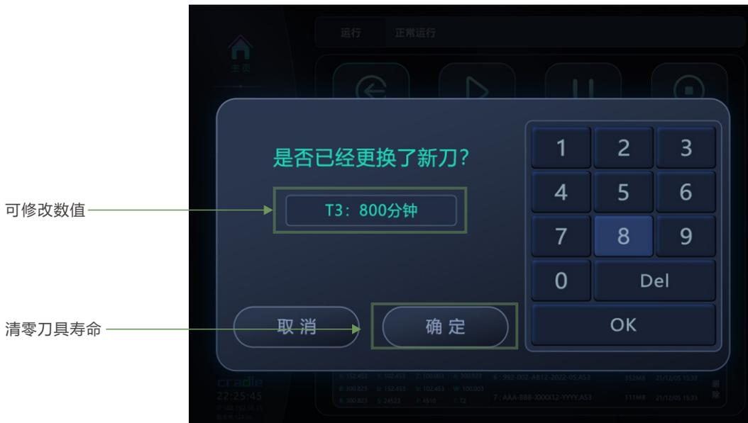
更换新刀具点击确定，加工寿命清零。右侧小键盘可修改车针加工寿命，按厂家提供的刀具寿命值设置（红刀1、4、7的寿命为2500分钟，2、5、8为1300分钟，3、6、9为900分钟；蓝刀1、4、7的寿命为5000分钟，2、5、8为2600分钟，3、6、9为1300分钟；紫刀1、4、7的寿命为8000分钟，2、5、8为4000分钟，3、6、9为2000分钟），也可以根据实际加工情况测试调整。
