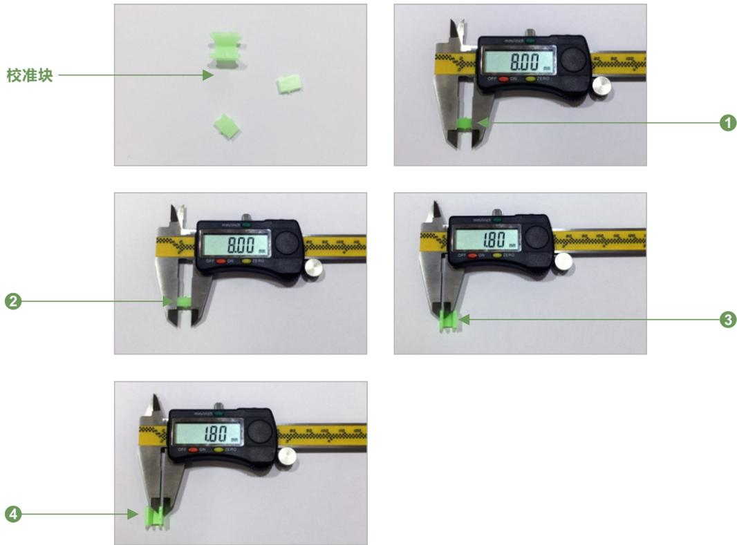
2. 用游标卡尺测量切好的客户端校准块，把对应的值填写上去。“.”的值填入X1，“..”的值填入X2，高度值填入Z。（每一个值测3次，取平均值）（正常来说，到这一步就完成校正，如果想校正验证的结果，可以进行下面的第3步）
